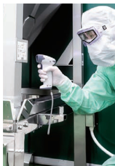
製造に用いる原材料を、MESに連結したバーコードで確認しています。
